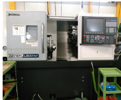
OKUMA GENOS L300-M (複合加工仕様) CNC旋盤 最大加工径：φ200 (mm) 最大加工長：450 (mm)
