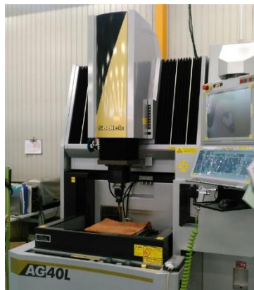
Sodick AG40L リニア駆動 高速形彫放電加工機 ストローク：400×300×270(mm)
